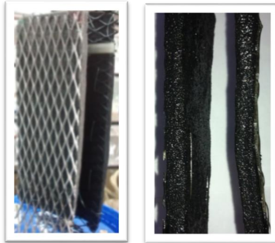
Imagen 18. Imágenes de los electrodos: (izquierda) electrodos con recubrimiento sin bio-película, al frente malla de titanio y fieltro de carbono recubiertos con níquel metálico, (derecha) electrodos en funcionamiento con la bio-película formada, izquierda ánodo
