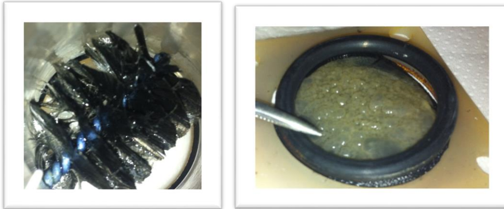
Imagen 34. Electrodos con la biopelícula formada durante el cambio de MFC a MEC para MEC C; (derecha) brush, (izquierda) Tela de Carbono
