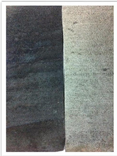
Imagen 20. (Izquierda) Filtro de carbono recubierto con óxido de rutenio, (Derecha) Filtro de carbono recubierto con níquel metálico
