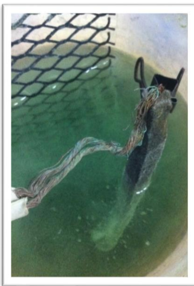
Imagen 10. Electrodeposición con níquel metálico sobre fieltro de carbono a 4 V
