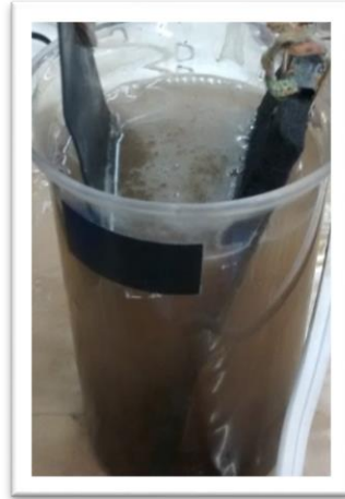
Imagen 11. Electrodeposición con \text{RuCl}_3 sobre filtro de carbono a 8 V
