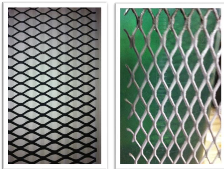
Imagen 19. (Izquierda) Malla de titanio recubierta con óxido de rutenio, (Derecha) Malla de titanio recubierta con níquel metálico
