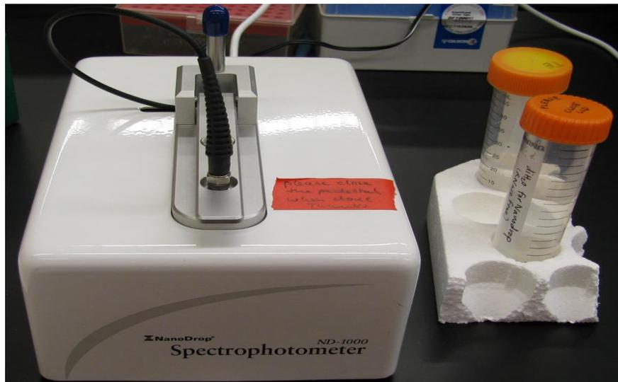
*Figura 13.- Espectrofotómetro NanoDrop-1000 utilizado para medir las concentraciones de ácido nucleico*
