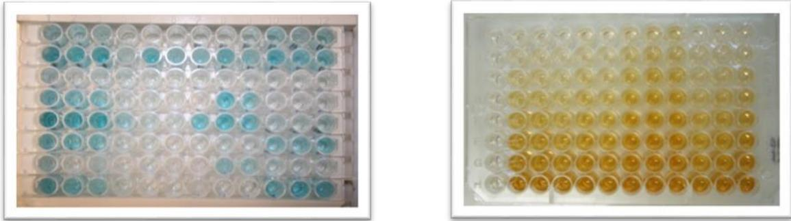
*Figura 15.- en la parte izquierda se observa la reacción con el sustrato que contiene peróxido de hidrogeno observándose una coloración azul, a la derecha la placa cuando se ha añadido la solución de paro reacción provocada por peroxidasa, para su análisis en el equipo.*
