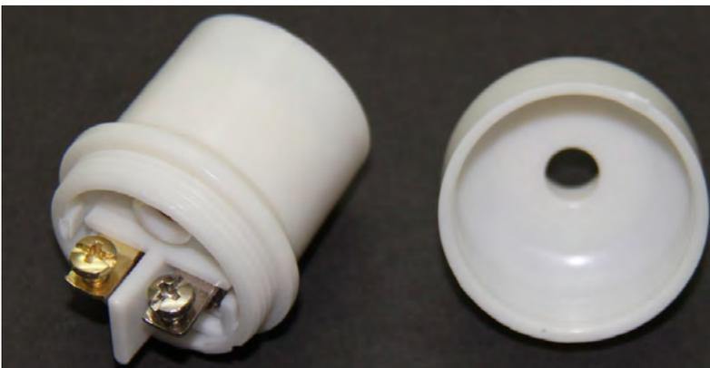
Para fijar el socket eléctrico a la pieza cerámica se utiliza un pasacables plástico. Este elemento consiste en dos partes: una pieza con cuerda que se enrosca a la tapa del socket y un tapón donde se enrosca la primera pieza. La pieza cerámica queda atrapada entre éstas dos.
