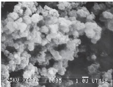
Figura 7 (a) Microscopia de barrido del Carbopol con un aumento de 200X^{(20)} .
