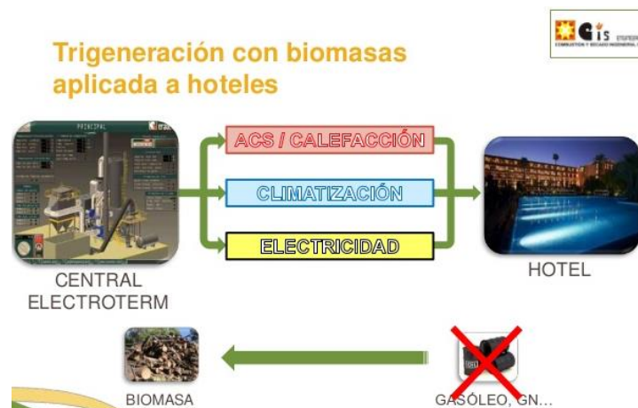
Figura 4: Esquema de planta de trigeneración tomado séptimo congreso internacional de bioenergía celebrado en Valladolid España en el 2012, se presento la exposición de tecnología de trigeneración aplicada a un hotel.
