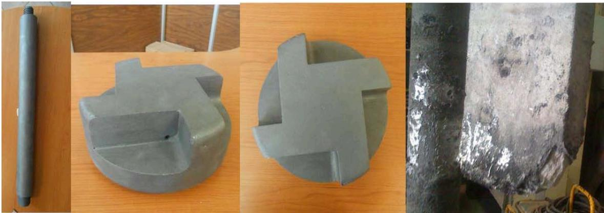
Figura 26. Componentes de la unidad de desgasificación para aplicar el tratamiento. Izquierda: lanza de grafito, centro: rotor de grafito tipo estándar vista lateral y superior, derecha: placa deflectora cerámica para romper el vórtice.
