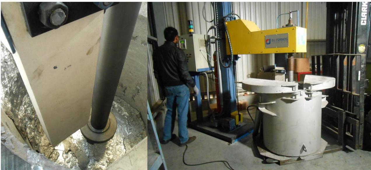
Figura 27. Izquierda, montaje del sistema de flecha, rotor y placa deflectora en la olla de tratamiento. Derecha, montaje completo de la unidad de desgasificación con la olla de tratamiento.
