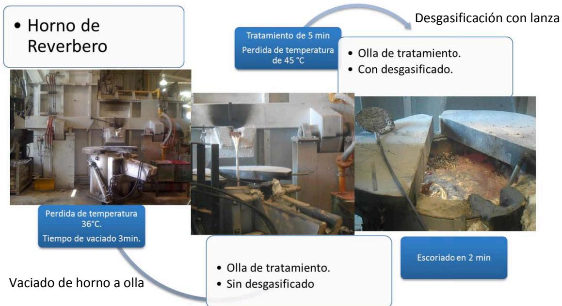
Figura 31. Diagrama del proceso de desgasificación con lanza actual en la empresa BSI. El tiempo total del proceso de desgasificado es de aproximadamente 10 min.
