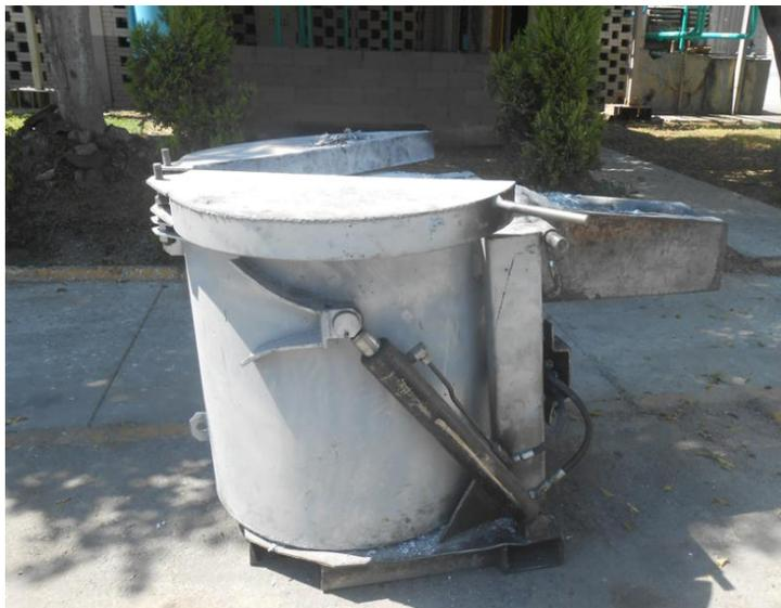
Figura 24. Olla de tratamiento (reactor) y de vaciado a hornos de retención.
