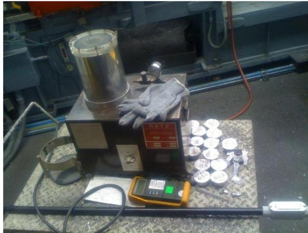
Figura 23. Equipo de presión reducida, pirómetro y termopar.
