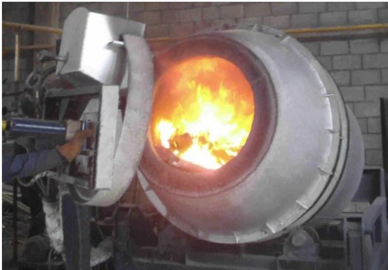
Figura 7. Horno rotativo (horno de reverbero mejorado). <sup>(8)</sup>
