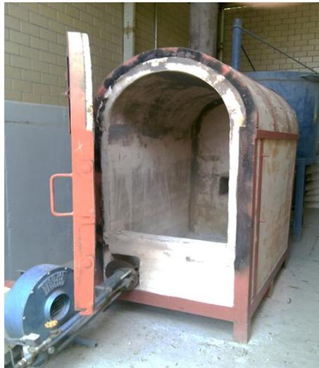
Figura 2. Incinerador de aire controlado.
