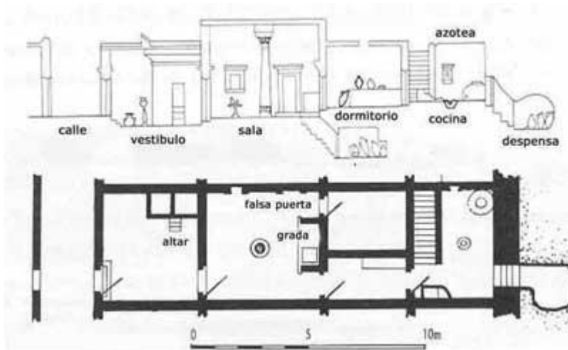
Imagen 3.7 Sección y planta de vivienda egipcia
