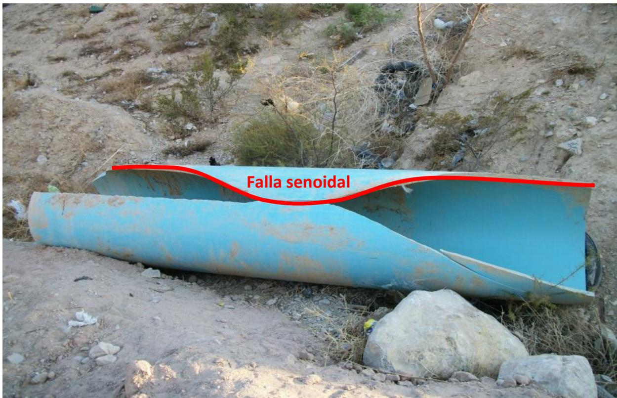
**Figura 5.24. Fractura rápida de forma senoidal en un tubo del acueducto Conejos-Médanos, producida cuando había aire atrapado**
