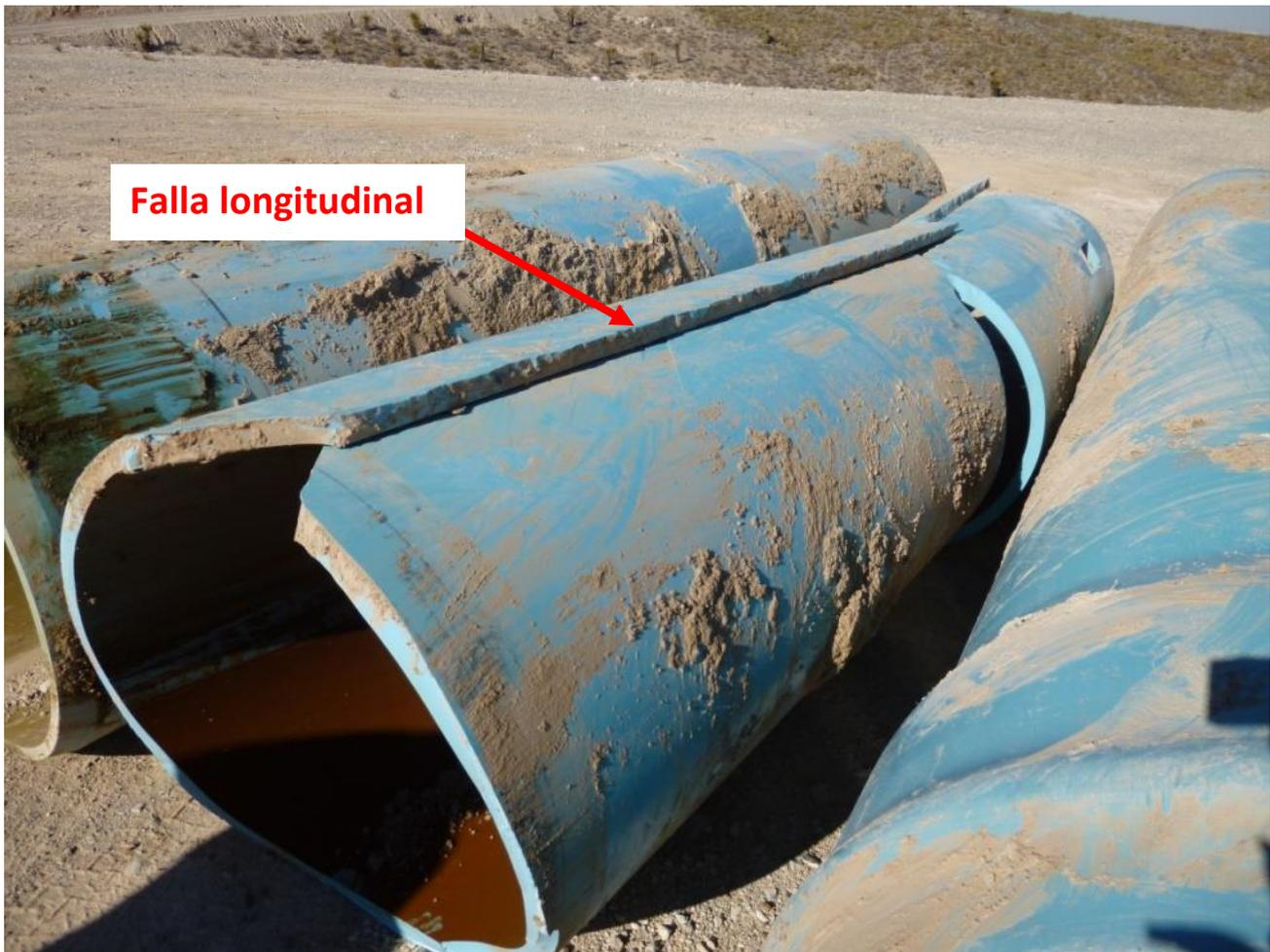
**Figura 5.25. Fractura rápida en forma longitudinal en un tubo del acueducto Conejos-Médanos, producida cuando había no aire atrapado**
