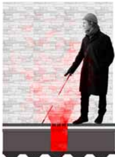
*Canaleta radiante para referencia térmica.
