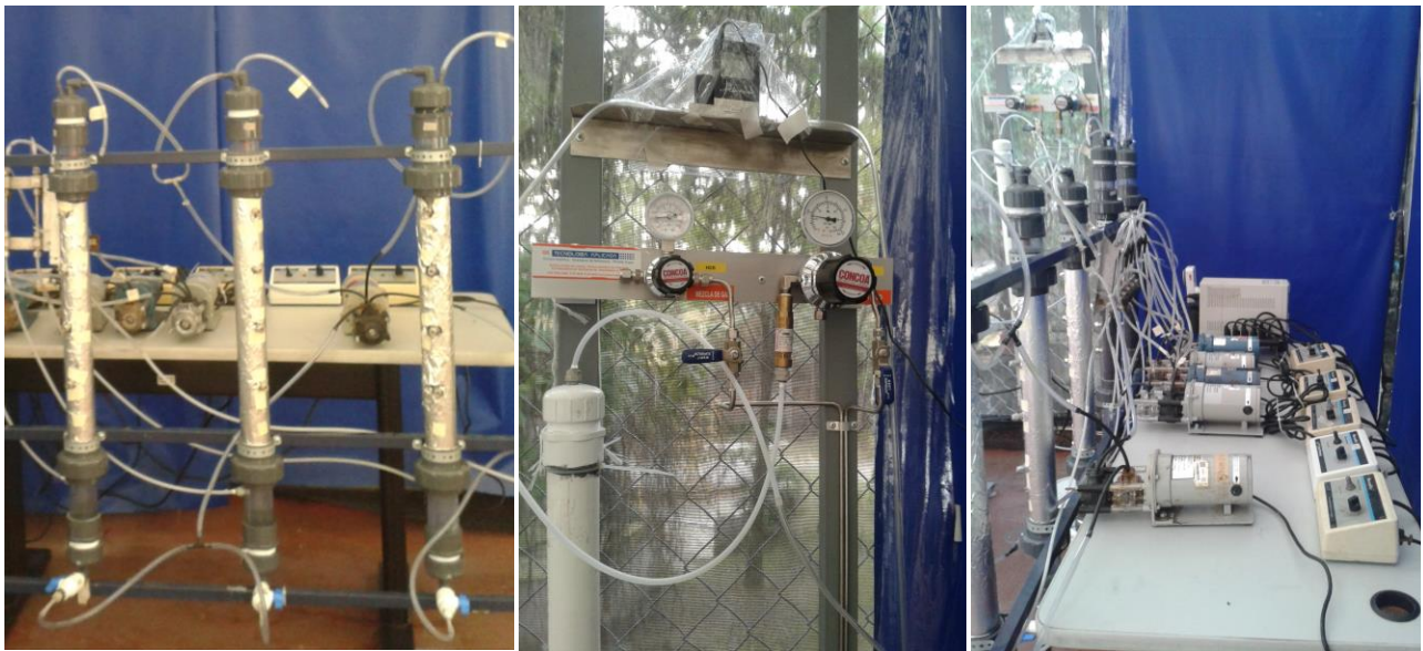
Figura 4.3 Operación del sistema de biofiltración utilizado en régimen continuo (la bolsa Tedlar se utiliza para muestrear la salida de la corriente gaseosa tratada).
