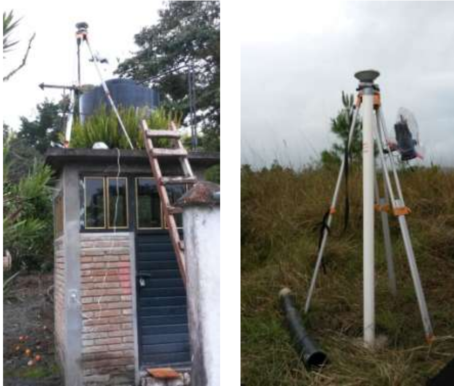
Figuras 6.2.4 y 6.2.4(1). Estaciones de medición satelital fija y móvil.
