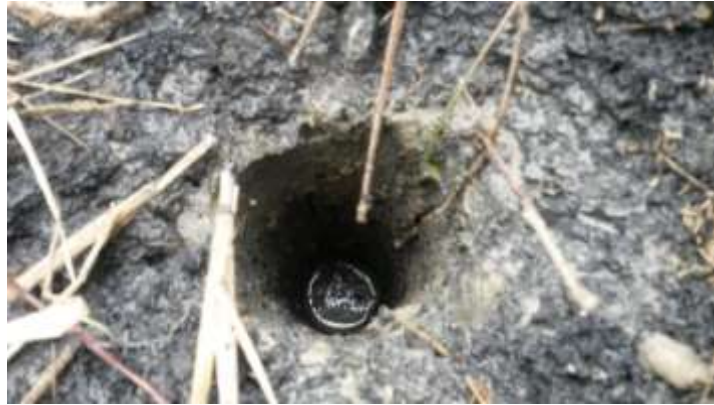
Figura 6.2(5). Nivel freático en la perforación
