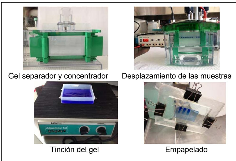
Figura 44. Técnica de electroforesis.
