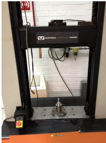
Figura 41. Compresor con contenedor para muestras confinadas.
