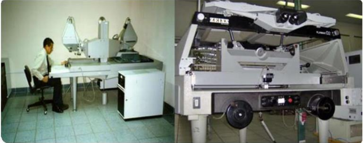
Imagen 7. Restituidores fotogramétricos Planimat D-2, un Ortoproyector Orto-3
