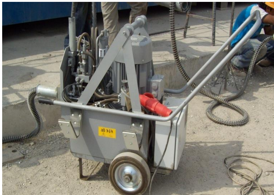
Figura IV.3.11.B Gato hidráulico para tensar. (Foto tomada por el autor)
