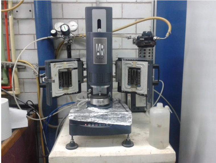
Imagen 1. Reómetro de esfuerzos controlados ARG2 (TA Instruments®)
