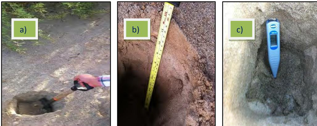
**Imágenes 4.1 Fotos de a) toma de muestra, b) medición de profundidad y c) determinación de pH.**
