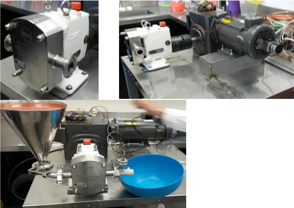
Reómetro extensional que se desarrolló en el CCADET, siguiendo las ecuaciones presentadas del número 17 al 22.
