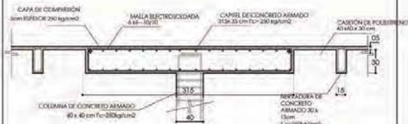
D-2 INTERSECCIÓN CAPITEL CON LOSA
