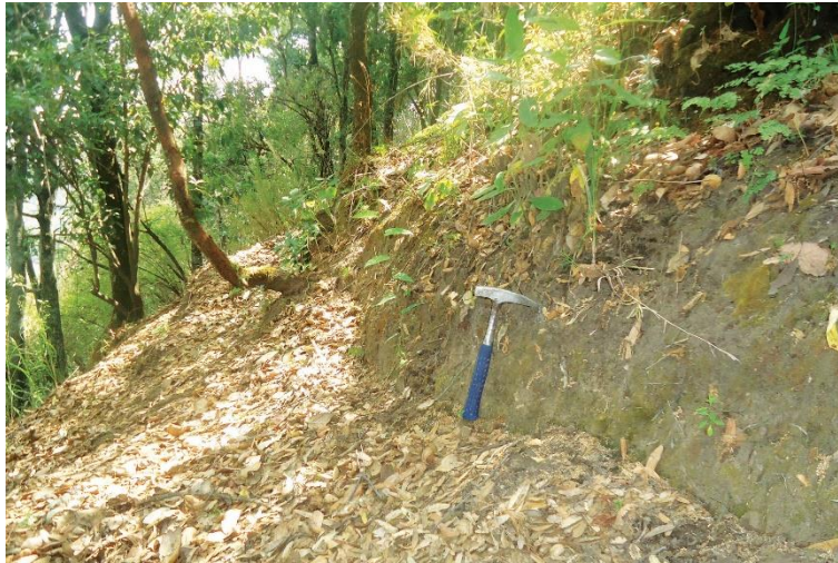
Figura 4.45. Fotografía C de la Zona 4, los desplazamientos verticales que se presentan en la ladera y que tienen presencia de musgo indican que el terreno se ha estabilizado y que el movimiento de reptación ha dejado de ocurrir.
