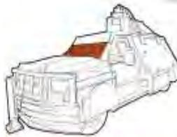
**Parabrisas reforzado.** Eliminan el vidrio y colocan una placa con orificios y vidrio blindado a base de Polycarbonato y vidrio Dúplex.
