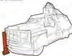
**Frente reforzado con tubo PTR calibre 14 de 4 x 4 pulgadas** y soleras metálicas de 3 pulgadas de ancho por 1/4 de grosor.
