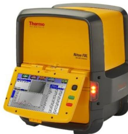
**Figura 19. Equipo de Fluorescencia de Rayos X de marca ThermoScientific, modelo Niton FXL959 (Thermo Scientific, 2013)**
