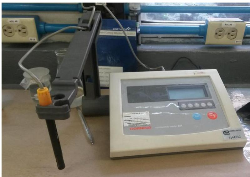
**Figura 21. Conductímetro utilizado, Corning modelo Conductivity meter 441 (Rico Malacara)**
