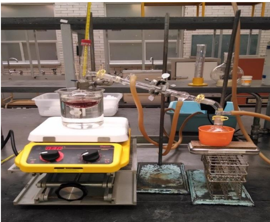
Fig.3.9 sistema de destilación juntas 14/23 utilizando el vaso de precipitado como baño maría
