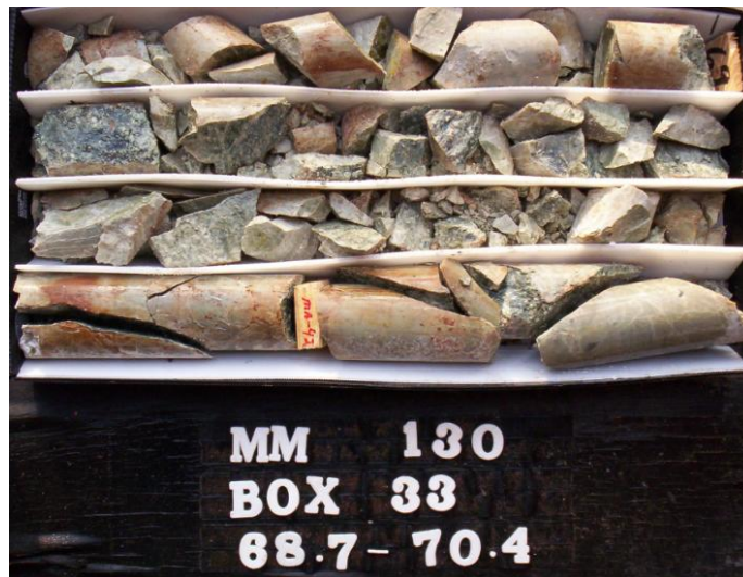
Figura 34. Toba riolítica intensamente fracturada, a 70 m de profundidad en el sondeo MM-130 se localiza el contacto intrusivo con cuarzomonzonita.
