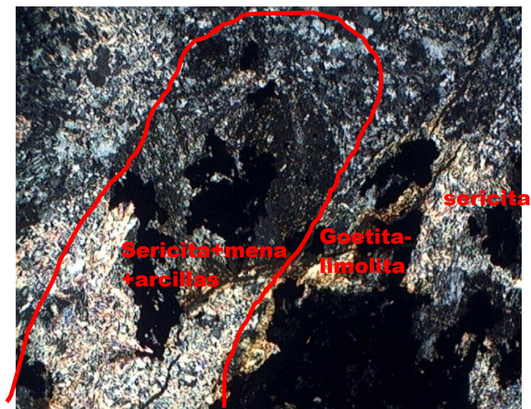
Figura 63. Reemplazamiento total de sericita+arcillas+mena sobre fenocristal de plagioclasa y rellenos de goetita-limolita en microfracturas (Microfotografía a 10X, luz polarizada). Barreno MM-117 a 24.5 metros de profundidad.
