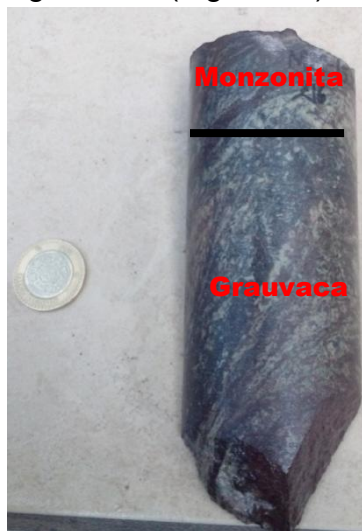
Figura 31. Contacto entre la grauavaca y la monzonita (barreno MM-216 a 15 m de profundidad desde la superficie del collar del barreno).
