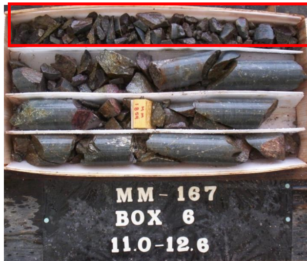
Figura 40. Andesita porfídica ubicada en el centro del cuerpo mineralizado de Iguana Prieta; se presenta un cambio a monzonita con un intenso fracturamiento (señalado en el cuadro rojo) en el contacto y una gran oxidación (se presenta óxidos de hierro y cobre) (barreno MM-167 entre los 11.0 y 12.6 m).
