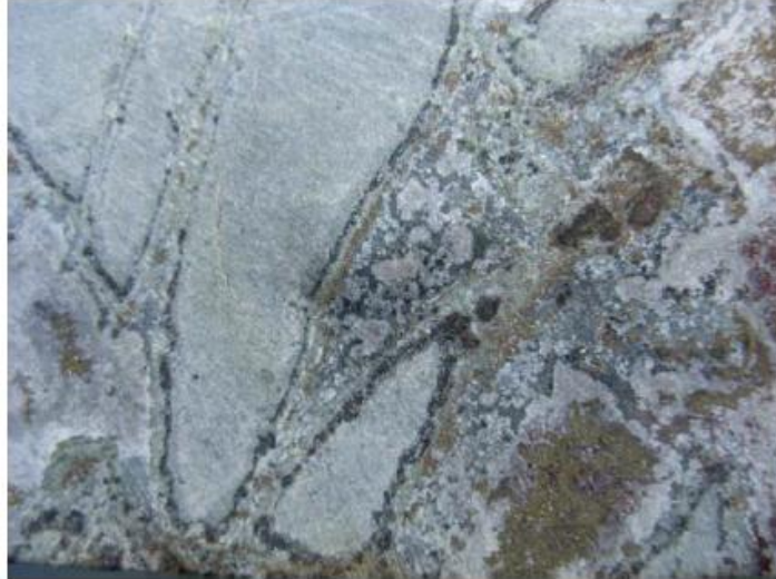
Figura 46. Cuarzomonzonita porfídica que muestra brechas monolíticas subangulosas con mineralización de pirita que reemplaza los bordes de los fragmentos, perteneciente al depósito de Iguana Prieta del barreno MM-122 a 143 mts de profundidad.
