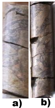
Figura 47. Partes de núcleos que muestran cuarzomonzonita con brechas angulosas de color marrón claro inmersa en una matriz fina de color negro que contiene diseminaciones de calcopirita y bornita. Barreno MM-173 a 32.5 m de profundidad al sur (a) y barreno MM-217 al sur a 34 m de profundidad (b).
