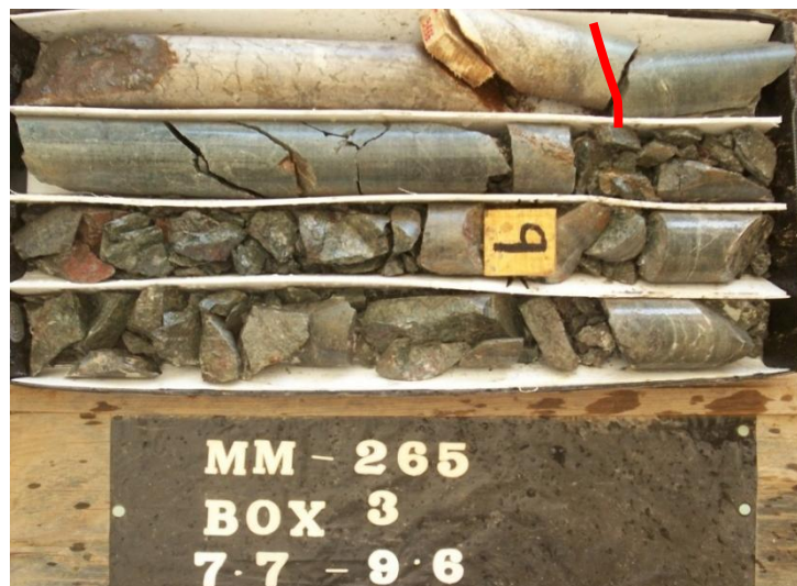
Figura 29. En la parte señalada se muestra un cambio de color de gris claro y ocre (perteneciente a la intrusión de la cuarzomonzonita) a gris oscuro azulado que representan a las coladas de andesita-basalto. Barreno MM-265 de 7.7 a 9.6 m.
