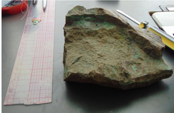
Figura 35. Muestra de mano de microgranodiorita intemperizada localizada cercana al contacto intrusivo con la cuarzomonzonita y la microgranodiorita en el lote de La Virgen. En ella se observa mineralización supergénica de malaquita y crisocola entre las fracturas.
