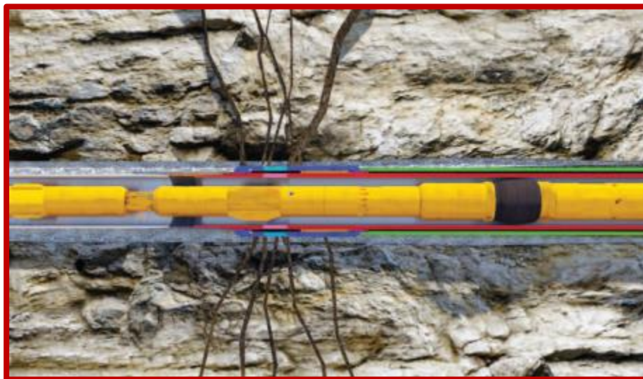
Figura 5.4. El sistema de fracturamiento OptiPort CT emplea mangas como las que se encuentran en los sistemas de esfera de deslizamiento. (Tomado de Greenberg, 2013)
