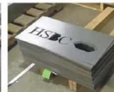
Todas la piezas de lamina se fabricaron en lámina de acero al carbón calibre 20, se escogió este espesor de lámina por la resistencia y el peso que esta daría al producto final.
