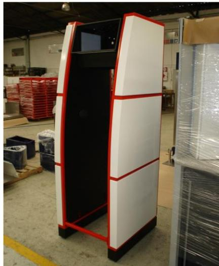
Después del ensamble se electrifica la caja de luz y se colocan los viniles autoadheribles con los gráficos para pasar a área de empaque y posteriormente al almacén.
