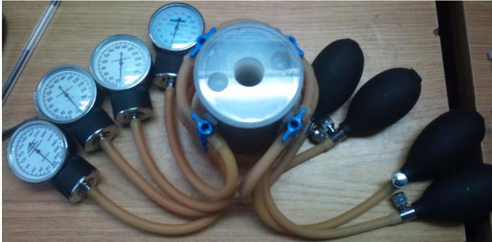
Figura 49. Estudio del incremento en la presión en cavidades vecinas.
