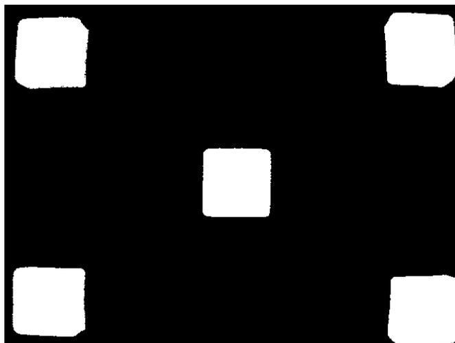
Figura 4.6 Imagen utilizada para obtener la relación entre píxeles y milímetros.
