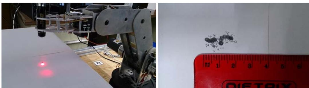
Figura 4.2 Método para encontrar la precisión del manipulador, con base en las marcas dejadas por un apuntador.
