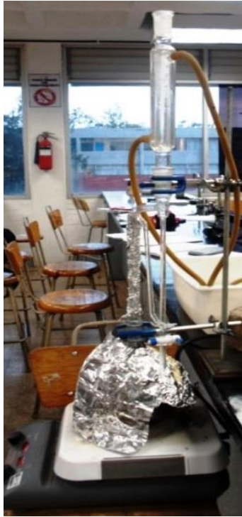
Fotografía 2. Equipo de hidrodestilación con trampa de Clevenger
