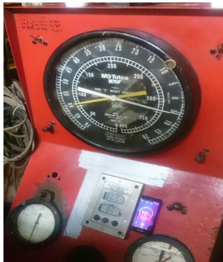
Figura 5.9 Instrumento para visualizar el peso al gancho.
