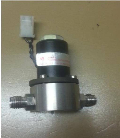
*Figura 4.37. Válvula de vacío 34PC01.*
