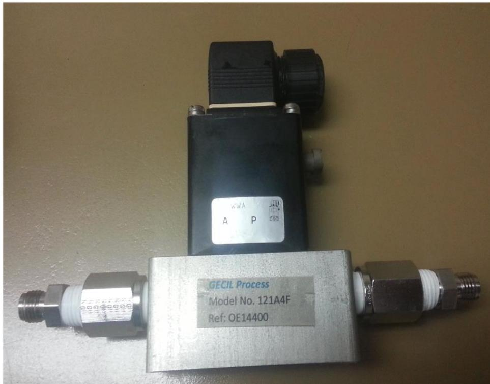
*Figura 4.32. Válvula de vacío EV-2.*
