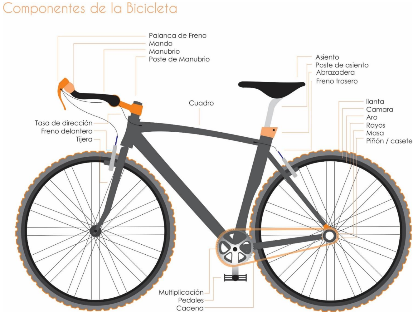
Figura 22: Componentes de la bicicleta
