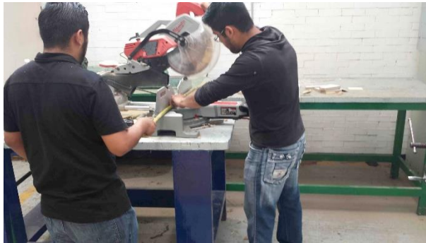
Figura 3.1.1.2.-Corte del carrizo con sierra circular.
