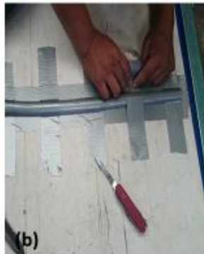
Figura 3.3.3.1.- (a) Chasis colocado sobre el banco de pruebas; (b) Colocación de obstáculos en la banda transportador; (c) Momento en el que la rueda pasa sobre el obstáculo.
