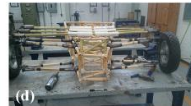
(a) y (b) Ensamble de base de carrizo con tubo de PVC; (c) Carrizos para empotrar la base, que lleva los tubos, al chasis; (d) Ajustando la posición a la cual estará empotrada la base al chasis.
