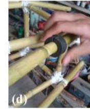
(a) Ensamble del chasis completo, tanto parte delantera como trasera; (b) Ajustando al tamaño las donas de hule que funcionó como buje; Haciendo una abertura a las donas de hule para ponerlas en el carrizo; (d) Dona de hule colocada en el chasis de carrizo.
