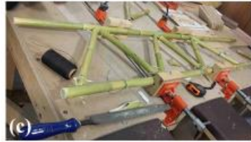
(a) Cortado de los carrizos al tamaño que se necesita; (b) Carrizos cortados al tamaño para hacer el subensamble; (c) Presentación del subensamble antes de sujetar con hilo; (d) Subensamble terminado con resina en los nodos.
