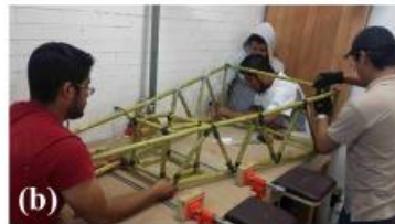
(a) Cortado de los carrizos al tamaño que se necesita; (b) Carrizos cortados al tamaño para hacer el subensamble; (c) Presentación del subensamble antes de sujetar con hilo; (d) Subensamble terminado con resina en los nodos.
