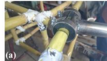
(a) Ensamble del chasis completo, tanto parte delantera como trasera; (b) Ajustando al tamaño las donas de hule que funcionó como buje; Haciendo una abertura a las donas de hule para ponerlas en el carrizo; (d) Dona de hule colocada en el chasis de carrizo.
