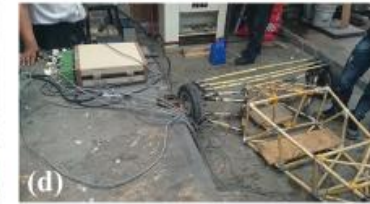
(a) Equipo P6000 con el que se hizo el monitoreo de las pruebas; (b) Tarjeta a la cual van conectados los cables (tres colores) soldados de las galgas y esta a su vez al equipo de medición; (c) Tarjetas conectadas al equipo; (d) Chasis instrumentado y conectado al P6000 para hacer las pruebas.
