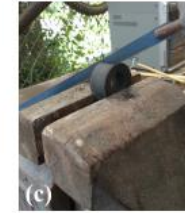
(a) Ensamble del chasis completo, tanto parte delantera como trasera; (b) Ajustando al tamaño las donas de hule que funcionó como buje; Haciendo una abertura a las donas de hule para ponerlas en el carrizo; (d) Dona de hule colocada en el chasis de carrizo.
