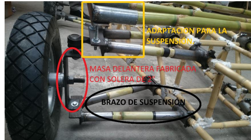
Elementos estructurales, así como de la suspensión de un brazo del eje delantero
