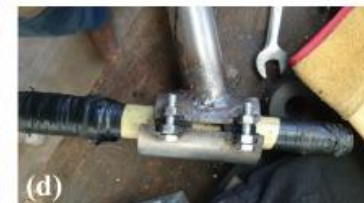
(a) Pieza de acero para acoplar brazos de la rueda, con buje de hule; (b) Ajustando los acoples metálicos para que no quedaran muy largos; (c) Dos coples metálicos que formaron los brazos para colocar en su posición la llanta; (d) Cople metálico unido por tuercas y tornillo.
