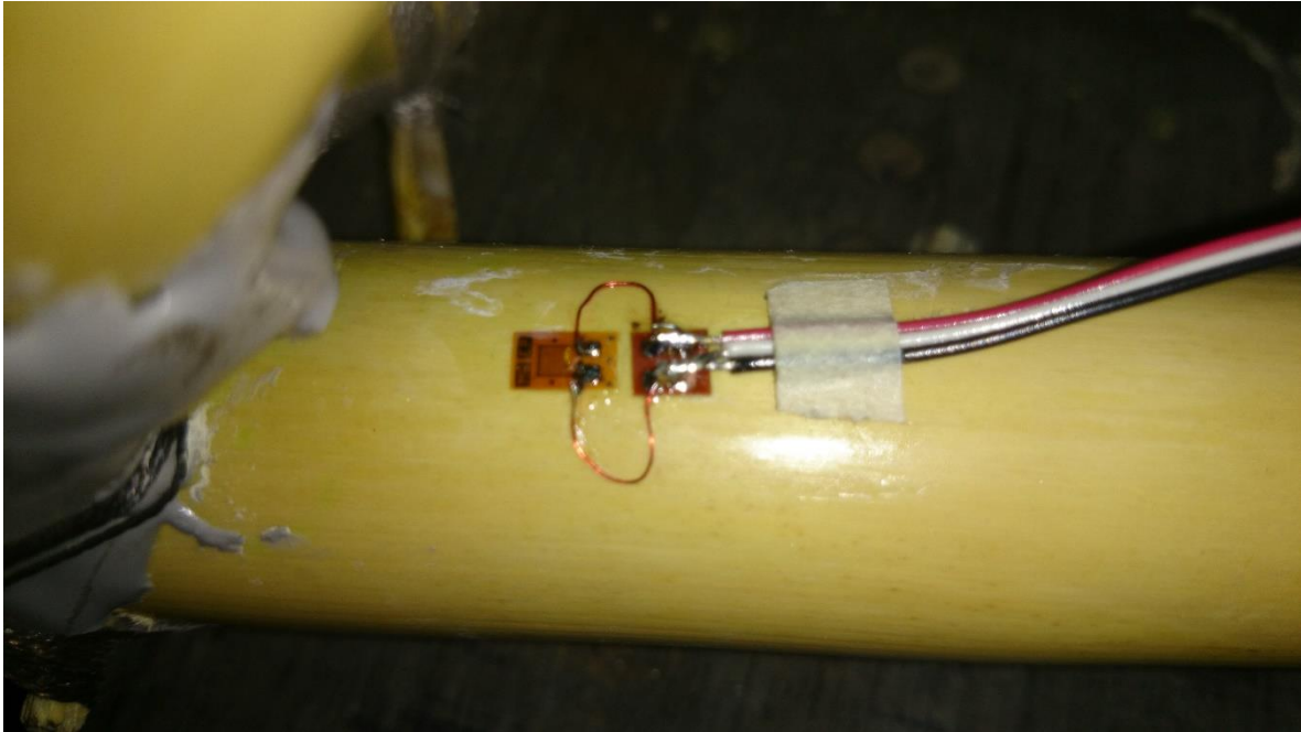
Figura 2.2.1.3. Extensómetro colocado sobre vara de carrizo
