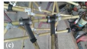
(a) Pieza de acero para acoplar brazos de la rueda, con buje de hule; (b) Ajustando los acoples metálicos para que no quedaran muy largos; (c) Dos coples metálicos que formaron los brazos para colocar en su posición la llanta; (d) Cople metálico unido por tuercas y tornillo.
