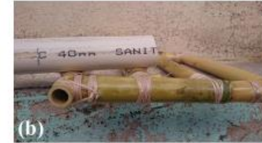
(a) Elaboración de la base que sostiene los tubo de la suspensión; (b) Base completa en la que se montaran 6 tubos de PVC para los brazos de la suspensión; (c) Elementos que van sujetos a la base anterior (Tubo PVC, tira de hule, abrazadera, tubo de carrizo); (d) Elementos acoplados que fungirán como elemento elástico de la suspensión.
