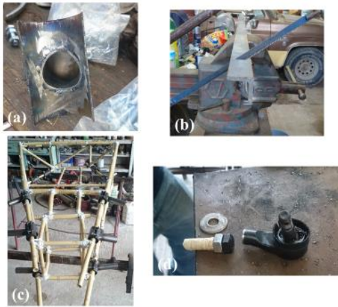
(a) Los coples metálicos se limaban para evitar daño a los bujes o el carrizo; (b) Cortando ángulo que funcionó como cople, en la llanta, para los brazos de la llanta; (c) Chasis con los 16 coples que van sujetos a este; (d) Adaptación de las rótulas.
