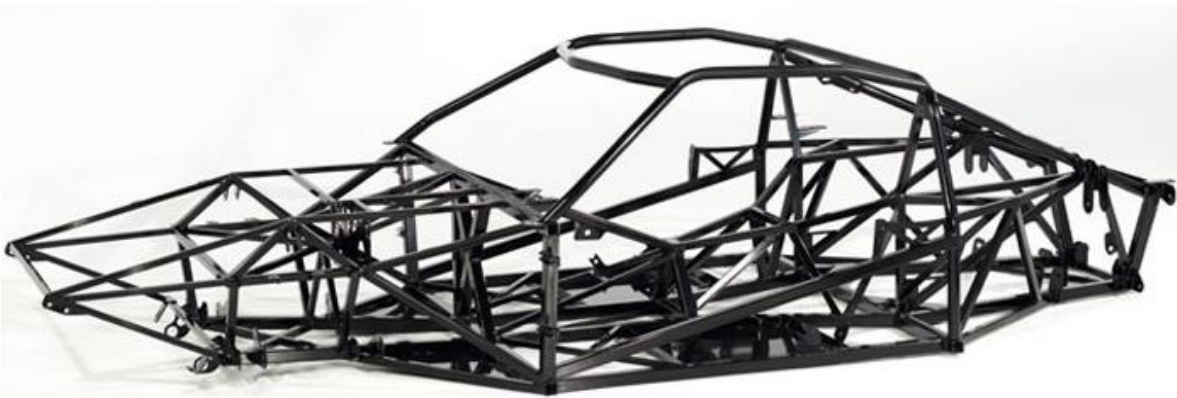
Figura 1.2.1.4.1.-Chasis tipo Space Frame.
