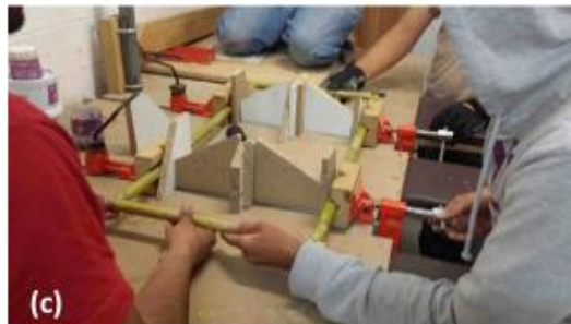
Figura 3.1.1.5 – (a) Preparación de un subensamblaje antes de unir los carrizos con hilo; (b) Ajustando el subensamblaje con tornillo sin fin; (c) Subensamblaje lateral terminado, unido con hilo y resina epóxica.
