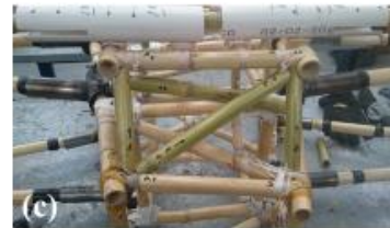
(a) y (b) Ensamble de base de carrizo con tubo de PVC; (c) Carrizos para empotrar la base, que lleva los tubos, al chasis; (d) Ajustando la posición a la cual estará empotrada la base al chasis.
