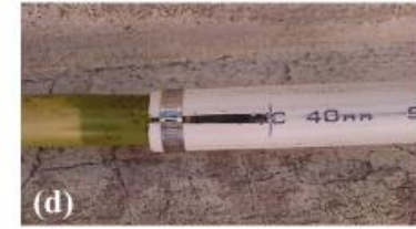
(a) Elaboración de la base que sostiene los tubo de la suspensión; (b) Base completa en la que se montaran 6 tubos de PVC para los brazos de la suspensión; (c) Elementos que van sujetos a la base anterior (Tubo PVC, tira de hule, abrazadera, tubo de carrizo); (d) Elementos acoplados que fungirán como elemento elástico de la suspensión.
