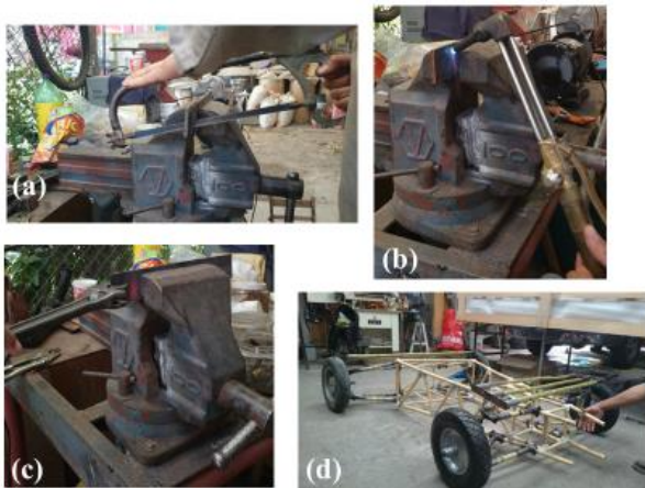
(a) Cortando de solera de 2" para fabricación de masa delantera; (b) Calentando con equipo de oxiacetileno para doblar la solera; (c) Doblando la solera con ayuda de una llave; (d) Chasis terminado sin reforzar.
