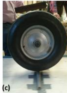
Figura 3.3.3.1.- (a) Chasis colocado sobre el banco de pruebas; (b) Colocación de obstáculos en la banda transportador; (c) Momento en el que la rueda pasa sobre el obstáculo.
