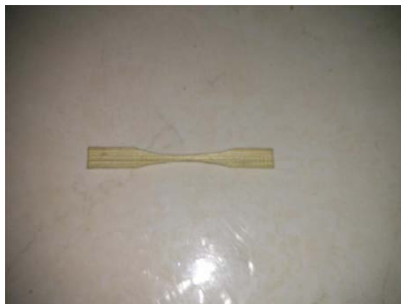
Figura 2.3.1.- Muestra con marcas generadas por la prensa, debido a la presión ejercida.
