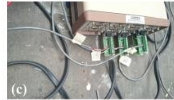
(a) Equipo P6000 con el que se hizo el monitoreo de las pruebas; (b) Tarjeta a la cual van conectados los cables (tres colores) soldados de las galgas y esta a su vez al equipo de medición; (c) Tarjetas conectadas al equipo; (d) Chasis instrumentado y conectado al P6000 para hacer las pruebas.
