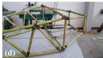
(a) Armado del cubo que va en la parte delantera; (b) Ensamble de los subensambles para formar la parte delantera del chasis; (c) Parte posterior del subensamble que soporta el motor; (d) Fijando la parte trasera, que soporta el motor, al chasis.
