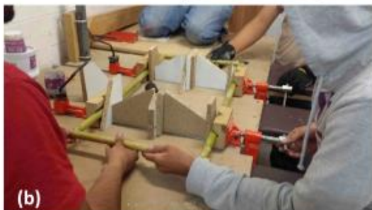
Figura 3.1.1.5 – (a) Preparación de un subensamblaje antes de unir los carrizos con hilo; (b) Ajustando el subensamblaje con tornillo sin fin; (c) Subensamblaje lateral terminado, unido con hilo y resina epóxica.
