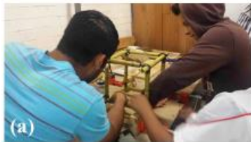
(a) Cortado de los carrizos al tamaño que se necesita; (b) Carrizos cortados al tamaño para hacer el subensamble; (c) Presentación del subensamble antes de sujetar con hilo; (d) Subensamble terminado con resina en los nodos.
