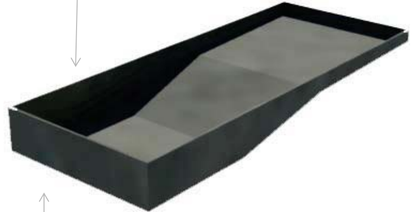
MUROS DE CONTENCIÓN PARA LA FOSA DE CLAVADOS (PROFUNDIDAD DE 5M)
