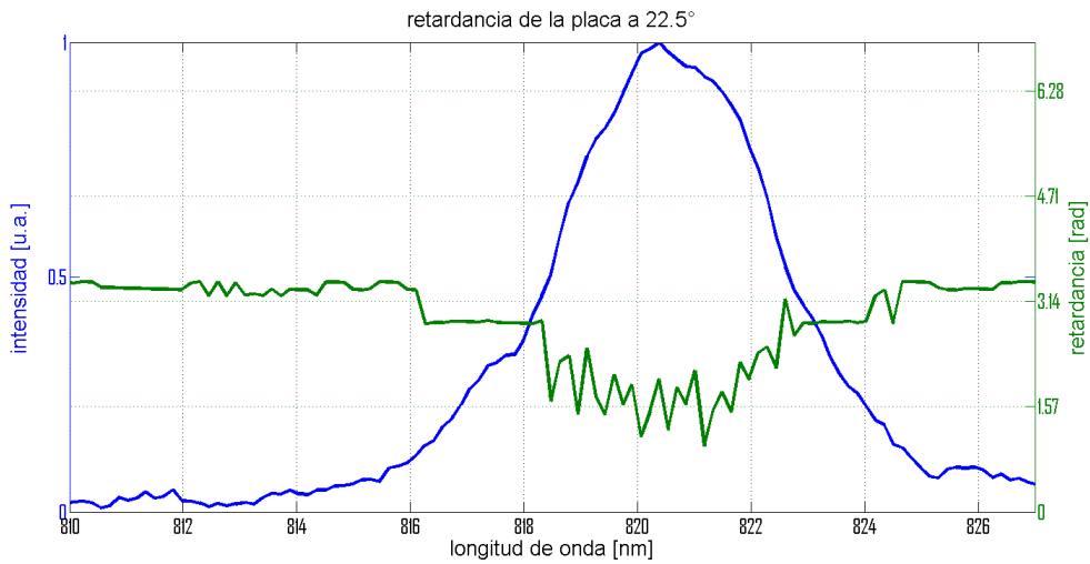
Figura 5.9: Retardancia del pulso al pasar por una placa retardadora de orden cero a un ángulo de 22.5^\circ .
