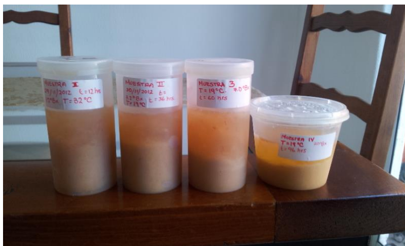
FIGURA 2.20 Muestras congeladas de mosto fermentado de acuerdo al avance de la fermentación
