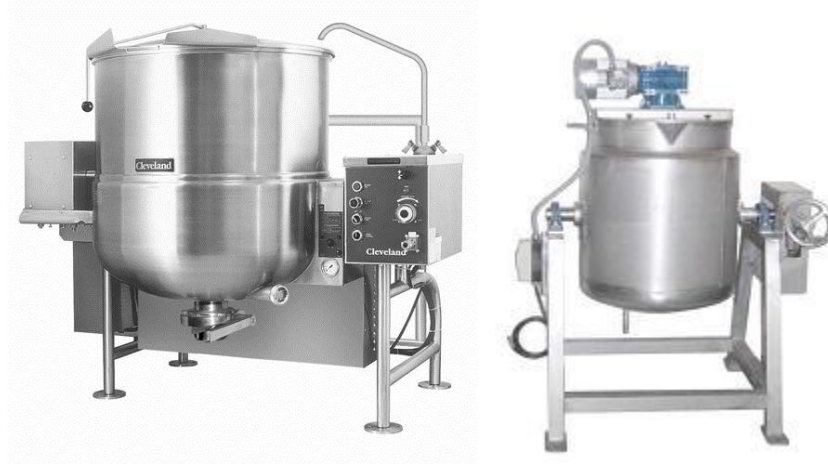
FIGURA 3.8 Evaporador tipo marmita izquierda (sin agitación) derecha (con agitación).
