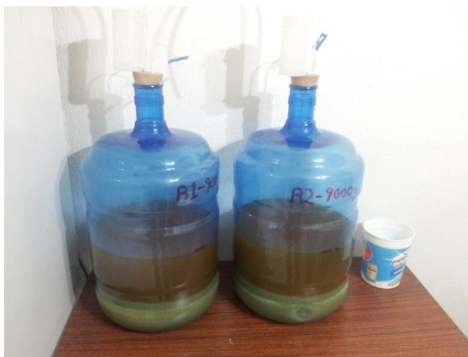
FIGURA 2.17 Sedimentación de la levadura muerta en el fermentador.
