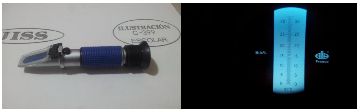
FIGURA 2.9 Refractómetro portátil y su escala interior
