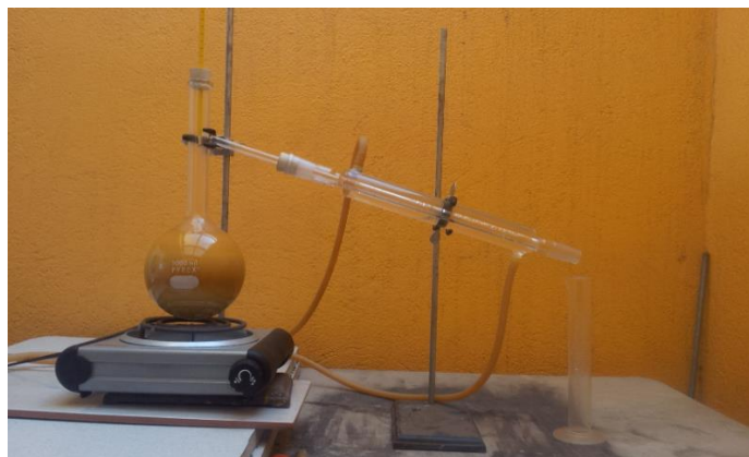
FIGURA 2.21 Sistema de destilación por lotes a pequeña escala
