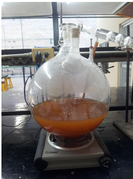
FIGURA 2.24 Cambio de apariencia del mosto y reducción del volumen dentro del destilador
