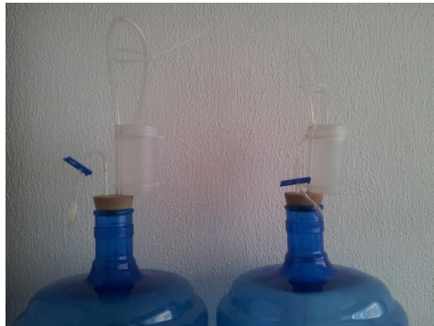
FIGURA 2.12 Válvula tipo Air-lock construida a partir de utensilios caseros
