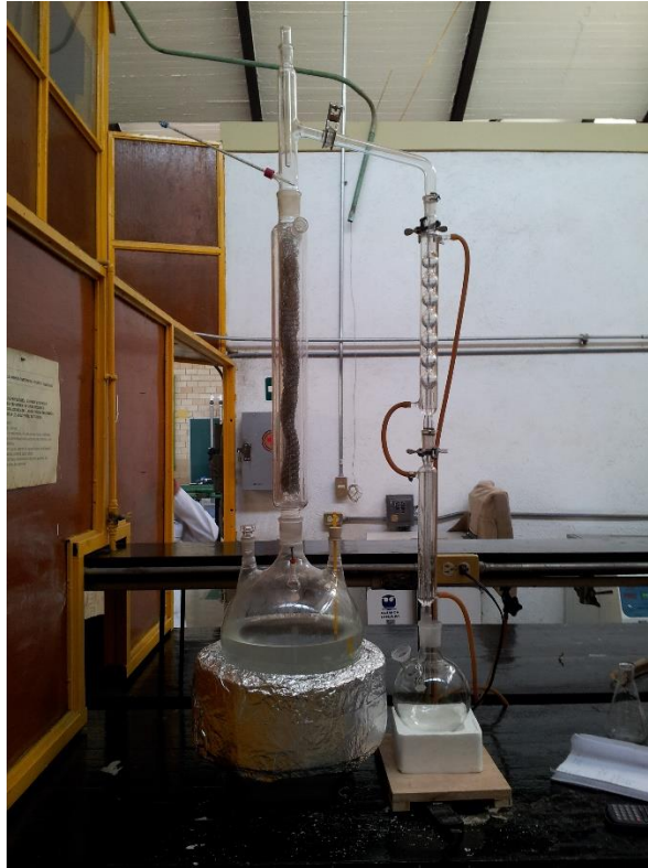
FIGURA 2.25 Equipo de destilación en columna utilizado en la depuración
