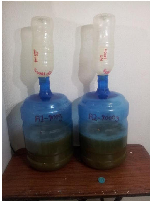
FIGURA 2.16 Crecimiento de levaduras en tanques fermentadores 20 L.
