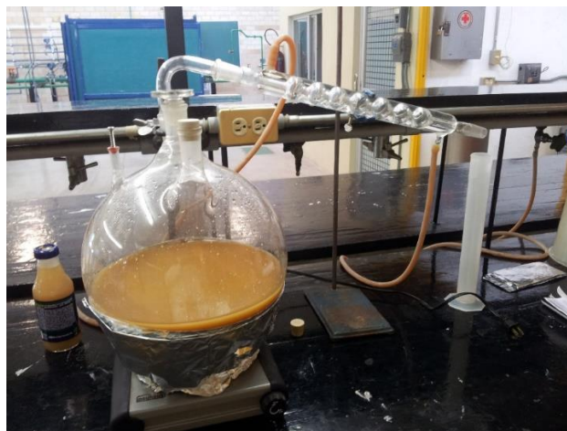
FIGURA 2.23 Sistema de destilación simple para mosto fermentado
