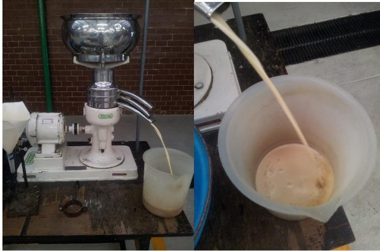
FIGURA 2.22 Centrifugado del mosto fermentado
