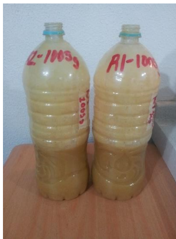
FIGURA 2.15 Formación de espuma excesiva dentro de los envases de fermentación
