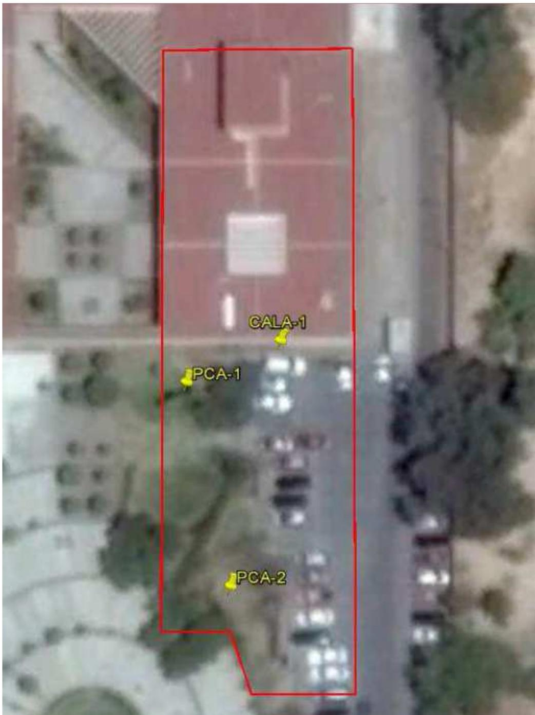
FIGURA 2.1 UBICACIÓN DE POZOS A CIELO ABIERTO PCA-1 Y PCA-2 Y DE LA CALA-1
