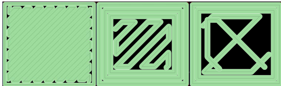
Figura 20. Diferentes estilos de llenado, de izquierda a derecha, estilo sólido, estilo espaciado y estilo espaciado de doble densidad.
