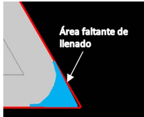
Figura 30. Área faltante de llenado en esquinas.
