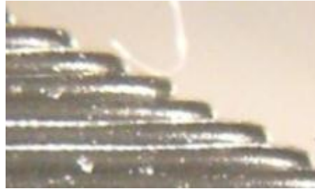
Figura 22. Efecto de escalonamiento en una construcción FDM [11].
