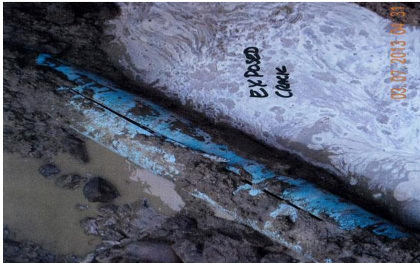
**Figura 4.16. Tubería de PVC de 16" con RD21 – Watford, ND – Falla tipo PRF de 400 metros de longitud (Palermo , 2010)**
