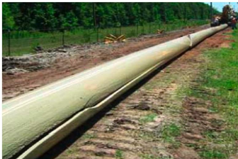
**Figura 4.5. Rotura del tipo PRF en una tubería fusible de PVC.**
