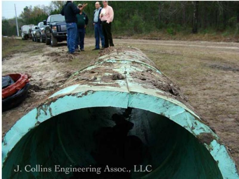
**Figura 4.7. Tubería de PVC de 20'' con RD 18 - Jacksonville, Clay County, FL– Falla tipo PRF de 183 metros de longitud (Palermo , 2010)**
