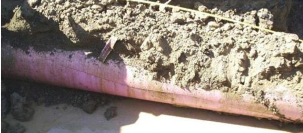
**Figura 4.6. Tubería de PVC de 20" con RD 18 - Danville, CA– Falla tipo PRF de 120 metros de longitud (Palermo , 2010)**
