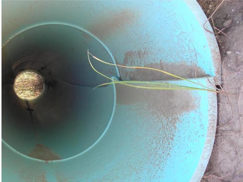
**Figura 4.11. Tubería de PVC de 24" con RD25 – Baton Rouge, LA– Falla tipo PRF de 260 metros de longitud (Palermo , 2010)**
