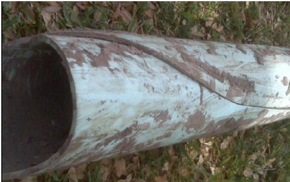
**Figura 4.10. Tubería de PVC de 8" con RD 25 – Tampa, FL – Falla tipo PRF de 60 metros de longitud (Palermo , 2010)**
