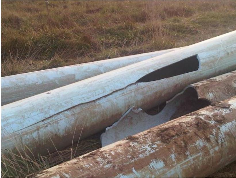
**Figura 4.13. Tubería de PVC de 30" con RD25 – Chatham, IL – Falla tipo PRF de 260 metros de longitud (Palermo , 2010)**
