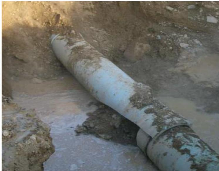
**Figura 4.4. Rotura del tipo PRF en un tubo con unión espiga-campana.**
