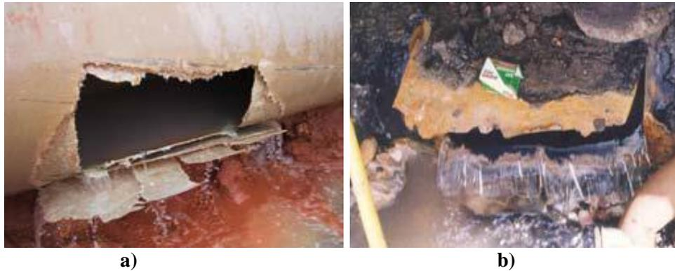
**Figura 3.5. a) Desgarre en una tubería de poliester reforzado con fibra de vidrio, b) Desgarre en una tubería de acero.**
