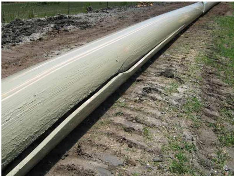
**Figura 4.8. Tubería de PVC de 20'' con RD 18 - Jacksonville, Clay County, FL– Falla tipo PRF de 500 metros de longitud (Palermo , 2010)**
