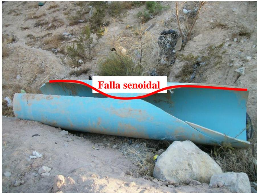
Figura 5.5. Rotura del tipo PRF en un tubo de PVC con presencia de aire atrapado ocurrido en el acueducto Conejos-Médanos de Ciudad Juárez Chihuahua, México.
