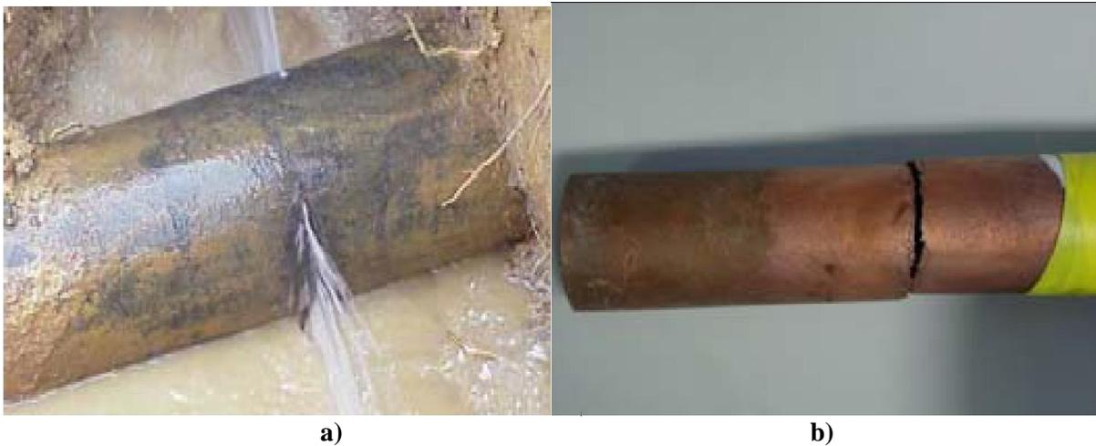
**Figura 3.1. a) Rotura circunferencial en una tubería de hierro, b) Rotura circunferencial en una tubería de cobre.**
