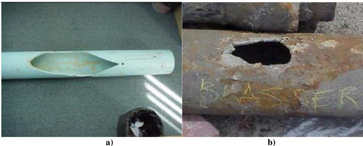
**Figura 3.4. a) Voladura en una tubería de PVC, b) Voladura en una tubería de hierro dúctil.**
