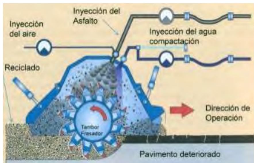
FIGURA 4.4.- PROCESO DEL ASFALTO ESPUMADO
