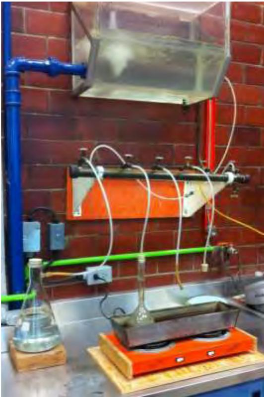
FIGURA 2.6 Equipo para determinar densidad de sólidos
