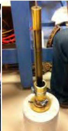
FIGURA 2.11 Uso del pisón para formar probetas
