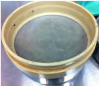
FIGURA 2.2 Cribado del suelo a través de malla #60
