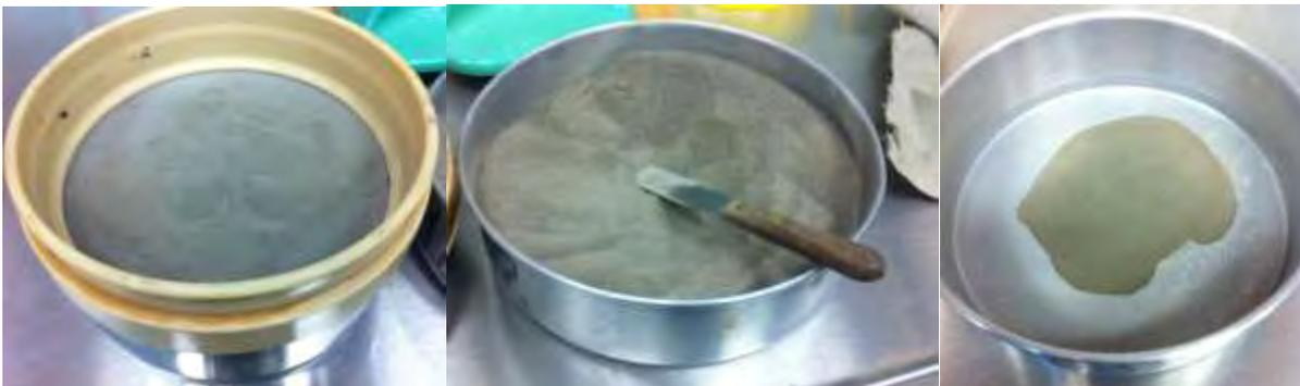
FIGURA 2.8 Material cribado por malla #60
