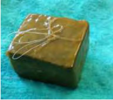
FIGURA 2.7 Espécimen para determinar peso específico
