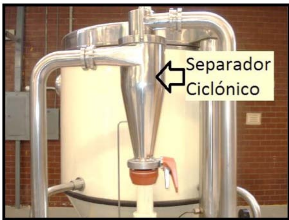
Figura 3.12: Separador Ciclónico del equipo Niro Atomizer LIQ Facultad de Química
