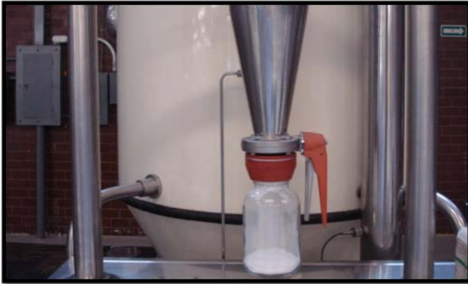
Figura 3.9: Recuperación del producto en el secador por aspersion
