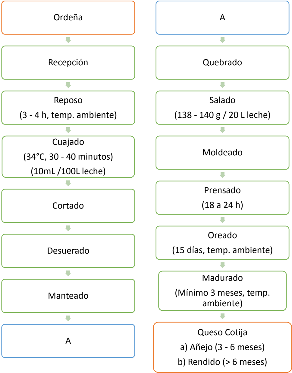
Figura 40. Diagrama de proceso de queso Cotija (Álvarez, et al. , 2005; García, 2011; Salto, 2013 y NMX – F – 735 – COFOCALEC - 2011).
