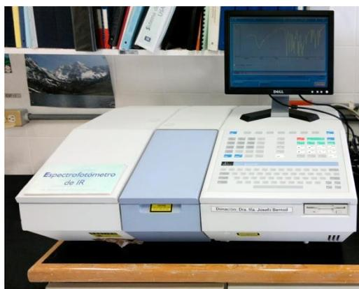
**Figura 4.18.** Espectroscopio de infrarrojo de transformada de Fourier
