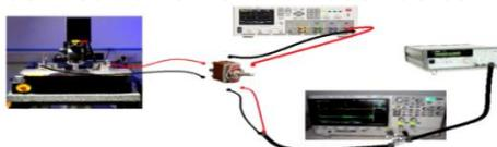
Fig.3.33- Configuración utilizada para llevar a cabo la medición de la resistencia de la muestra fabricada.
