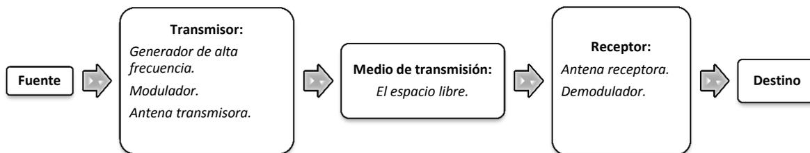
Fig. 1.1- Esquema convencional de un Sistema de Radiocomunicaciones.
