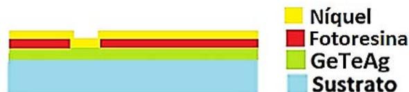
Fig.3.43- Vista lateral de Níquel depositado sobre la fotoresina con el patrón transferido que a su vez está depositado sobre GeTeAg que al mismo tiempo está depositado en el Sustrato.
