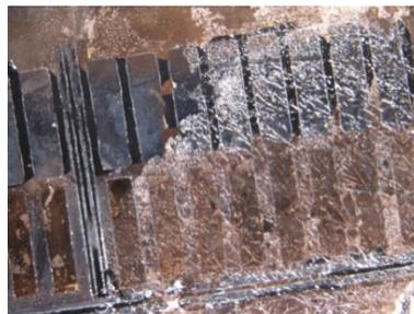
Fig.3.49- Vista superior de la parte central del dispositivo fabricado en donde existe la destrucción de la unión Níquel-GeTeAg-Ag
