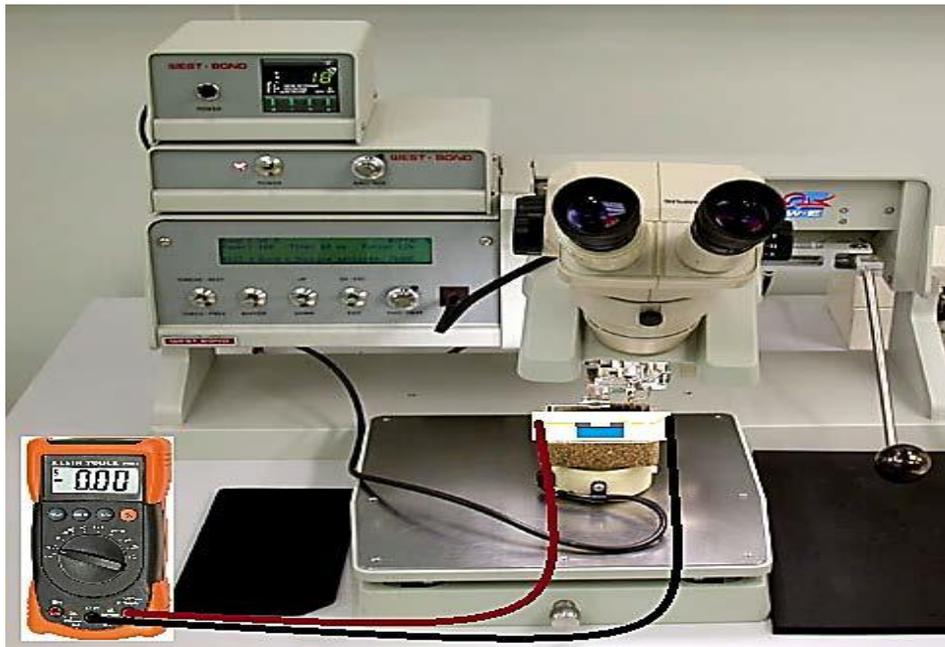
**Fig.2.15- Configuración utilizada para medir la resistencia de un depósito en estado amorfo de una película delgada de *GeTe* en función de la temperatura.**
