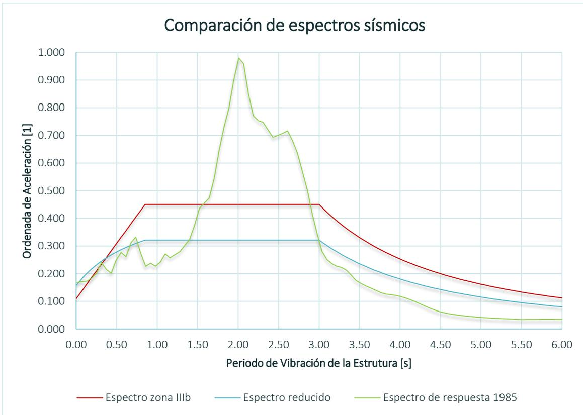
Figura III.8 Comparación de espectros de diseño y espectro de respuesta del sismo de 1985
