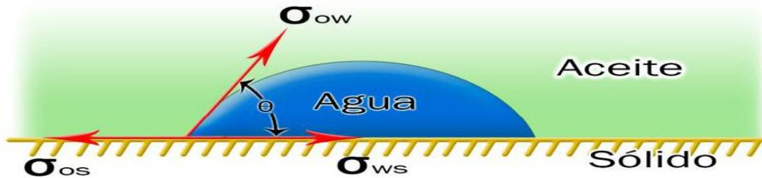
**Fig. 4.3.-** Tensiones interfaciales de un sistema en equilibrio.
