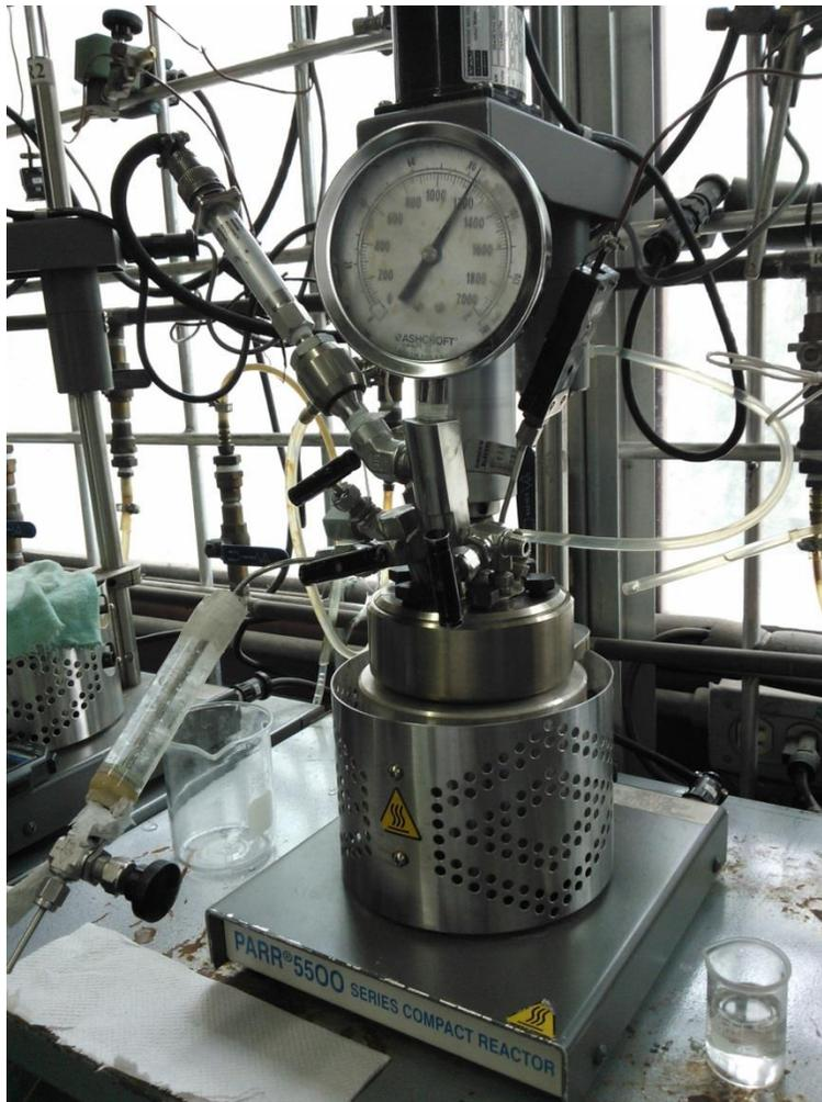
**ILUSTRACIÓN 3-1 REACTOR BATCH UTILIZADO PARA LAS PRUEBAS CATALÍTICAS.**
