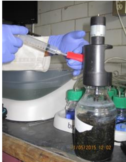
Figura 4.8 Reactor con pulsos de aireación
