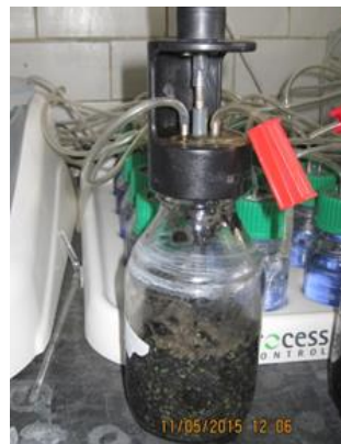
Figura 4.9 Reactor con inóculo adaptado
