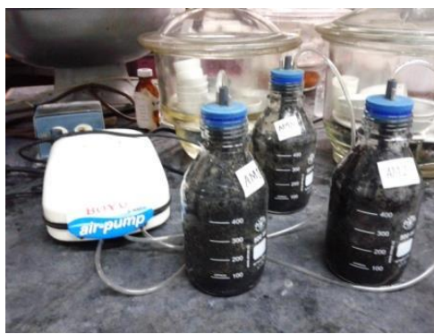
Figura 4.6 Reactor con pretratamiento de aireación
