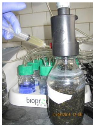
Figura 4.7 Reactor con alimentación continua de lixiviado
