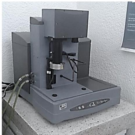
*Figura 33. Aparato de Termogravimetría (TGA).*
