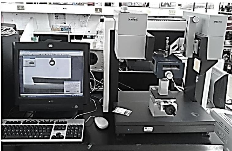
*Figura 34. Aparato para medición del ángulo de contacto.*
